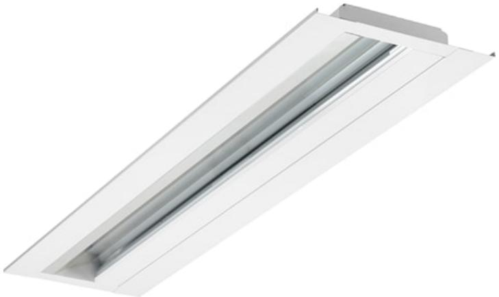
OPTIX ASYMETRIC E 1200 31W 3480lm 840 SSC BLA. Luminaire LED à encastrer, avec optique asymétrique. Gestion d'éclairage SylSmart Standalone. Flux lumineux 3480lm, efficacité lumineuse 112lm/W. Blanc neutre 4000K, IRC80. Groupe de risque photobiologique GR0. Dimensions 1196x293x52mm. Durée de vie 100 000h (L80). Garantie 5 ans
