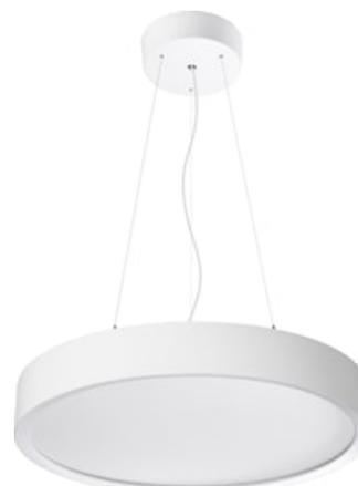
Colossal400 20,5W 2460lm OPAL Blanc 830 SSC. Luminaire architectural de grand diamètre (400mm). Installation saillie ou suspendue. Cerclage aluminium sans soudure. Colorie blanc (RAL9016). Garantie 5 ans. Fabriqué en France. Efficacité lumineuse : 120lm/W. Optique opale. SDCM $\leq$ 3, IRC $>$ 80. 650°C, classe 1. RG0. SylSmart Standalone. IP40, IK07. Dimensions : 400x93mm. Durée de vie : 66.000h (L90).
