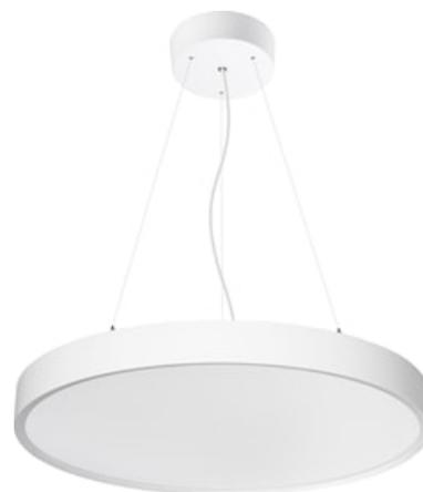
Colossal600 40,6W 5075lm OPAL Blanc 830. Luminaire architectural de grand diamètre (600mm). Installation saillie ou suspendue. Cerclage aluminium sans soudure. Colorie blanc (RAL9016). Garantie 5 ans. Fabriqué en France. Efficacité lumineuse : 125lm/W. Optique opale. SDCM $\leq$ 3, IRC $>$ 80. 650°C, classe 1. RG0. IP40, IK07. Dimensions : 604x93mm. Durée de vie : 66.000h (L90).
