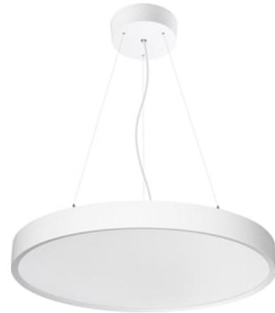
Colossal600 31,3W 3805lm PRIS Blanc 830 SSC. Luminaire architectural de grand diamètre (600mm). Installation saillie ou suspendue. Cerclage aluminium sans soudure. Colorie blanc (RAL9016). Garantie 5 ans. Fabriqué en France. Efficacité lumineuse : 122lm/W. Optique prismatique, UGR<19. SDCM≤3, IRC>80. 650°C, classe 1. RG0. SylSmart Standalone. IP40, IK07. Dimensions : 604x93mm. Durée de vie : 66.000h (L90).
