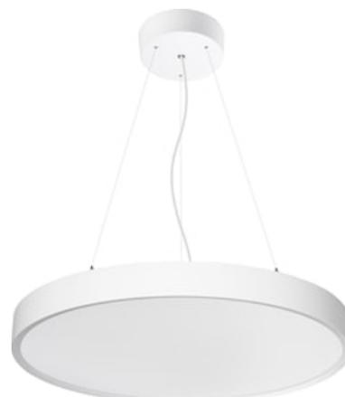
Colossal600 31,3W 3900lm PRIS Blanc D/I830. Luminaire architectural de grand diamètre (600mm). Installation saillie ou suspendue. Cerclage aluminium sans soudure. Colorie blanc (RAL9016). Garantie 5 ans. Fabriqué en France. Efficacité lumineuse : 125lm/W. Optique prismatique, UGR<19. Distribution directe et indirecte. SDCM≤3, IRC>80. 650°C, classe 1. RG0. IP40, IK07. Dimensions : 604x93mm. Durée de vie : 66.000h (L90).
