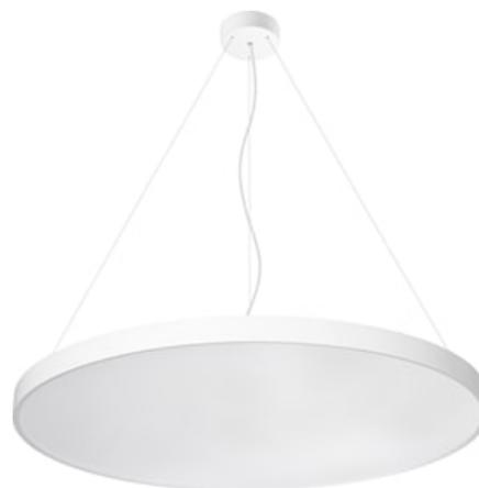
Colossal1200 153,6W 22015lm OPAL Blanc 840 SSC. Luminaire architectural de grand diamètre (1200mm). Installation saillie ou suspendue. Cerclage aluminium sans soudure. Colorie blanc (RAL9016). Garantie 5 ans. Fabriqué en France. Efficacité lumineuse : 143lm/W. Optique opale. SDCM $\leq$ 3, IRC $>$ 80. 650°C, classe 1. RG0. SylSmart Standalone. IP40, IK07. Dimensions : 1168x93mm. Durée de vie : 66.000h (L90).
