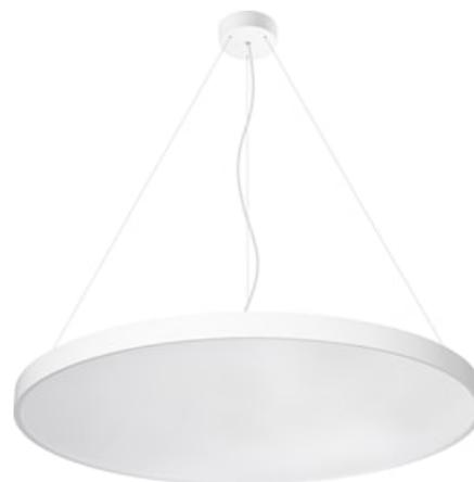
Colossal1200 153,6W 21130lm OPAL Blanc D/I830 DALI. Luminaire architectural de grand diamètre (1200mm). Installation saillie ou suspendue. Cerclage aluminium sans soudure. Colorie blanc (RAL9016). Garantie 5 ans. Fabriqué en France. Efficacité lumineuse : 138lm/W. Optique opale. Distribution directe et indirecte. SDCM $\leq$ 3, IRC $>$ 80. 650°C, classe 1. RG0. DALI-2. Ok bouton poussoir. IP40, IK07. Dimensions : 1168x93mm. Durée de vie : 66.000h (L90).
