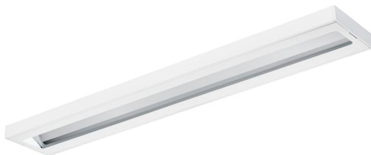
OPTIX ASYMETRIC S 1200 30W 3380lm 830 DALI - Luminaire LED à monter en saillie ou suspendu, avec optique asymétrique. Dimmable DALI (compatible bouton poussoir). Flux lumineux 3380lm, efficacité lumineuse 113lm/W. Blanc chaud 3000K, IRC80. Groupe de risque photobiologique GR0. Dimensions 1200x200x50mm. Durée de vie 100 000h (L80). Garantie 5 ans
