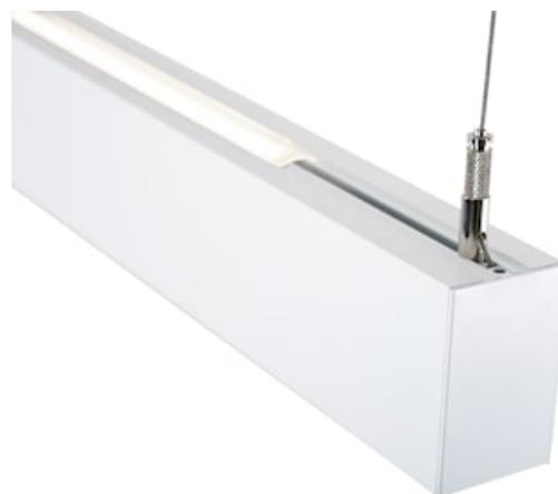
Luminaire LED linéaire, pour installation suspendue. Module pour la réalisation de lignes continues. Longueur 2400mm. Finition blanche. Diffuseur opale. Eclairage direct/indirect (65/35%) adressable séparément via DALI. Flux 8100lm, efficacité lumineuse 140lm/W. Température de couleur : blanc neutre (4000K). IRC > 80 / SDCM < 3. Groupe de risque photobiologique GR0. IP20 / IK03. Durée de vie 92 500 heures (L80). Garantie 5 ans.
