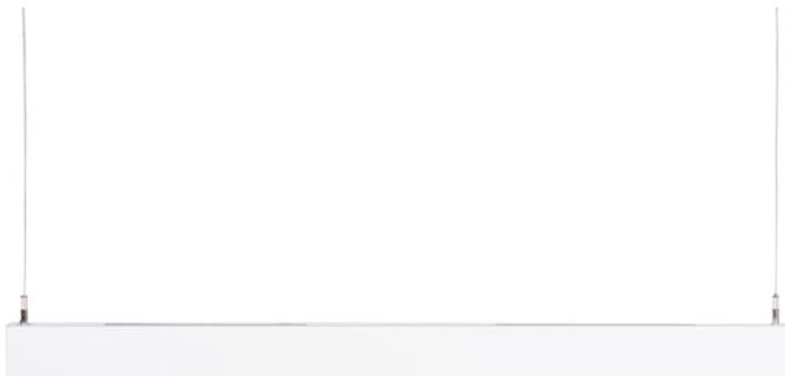
Luminaire LED linéaire, pour installation suspendue. Kit pré-câblé et pré-équipé avec embouts et câbles de suspension. Longueur 1200mm. Finition blanche. Diffuseur opale. Eclairage direct/indirect (65/35%) adressable séparément via DALI. Flux 4050lm, efficacité lumineuse 140lm/W. Température de couleur : blanc neutre (4000K). IRC > 80 / SDCM < 3. Groupe de risque photobiologique GR0. IP20 / IK03. Durée de vie 92 500 heures (L80). Garantie 5 ans.
