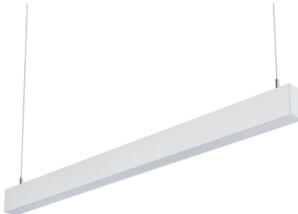
Luminaire LED linéaire, pour installation suspendue. Kit pré-câblé et pré-équipé avec embouts et câbles de suspension. Longueur 2400mm. Finition blanche. Diffuseur prismatique. Eclairage direct. Dimmable DALI. Flux 4600lm, efficacité lumineuse 128lm/W. Température de couleur : blanc neutre (4000K). IRC > 80 / SDCM < 3. Groupe de risque photobiologique GR0. IP20 / IK03. Durée de vie 92 500 heures (L80). Garantie 5 ans.
