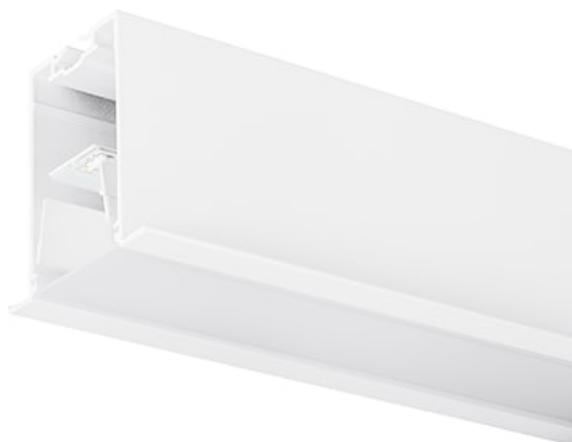
Luminaire LED linéaire, pour installation encastrée. Module avec bords pour la réalisation de lignes continues. Longueur 1200mm. Finition blanche. Diffuseur opale. Eclairage direct. Dimmable DALI. Flux 2400lm, efficacité lumineuse 133lm/W. Température de couleur : blanc neutre (4000K). IRC > 80 / SDCM < 3. Groupe de risque photobiologique GR0. IP20 / IK03. Durée de vie 92 500 heures (L80). Garantie 5 ans.
