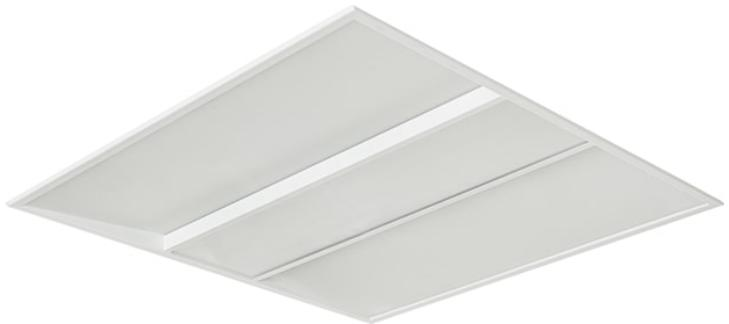
Luminaire LED encastré architectural avec optique micro-prismatique et distribution semi-directe de la lumière. UGR<19. Version haute efficacité (HE) : 140lm/W. Flux lumineux : 3300lm. Température de couleur blanc neutre (4000K). IRC80. Caisson fermé (finition blanc RAL 9016) réduisant la pénétration de la poussière et améliorant le facteur de maintenance du luminaire (LMF). IP20, IK03. Dimensions : 595mm x 595mm x 92mm. Durée de vie 100 000 heures (L80). Garantie 5 ans
