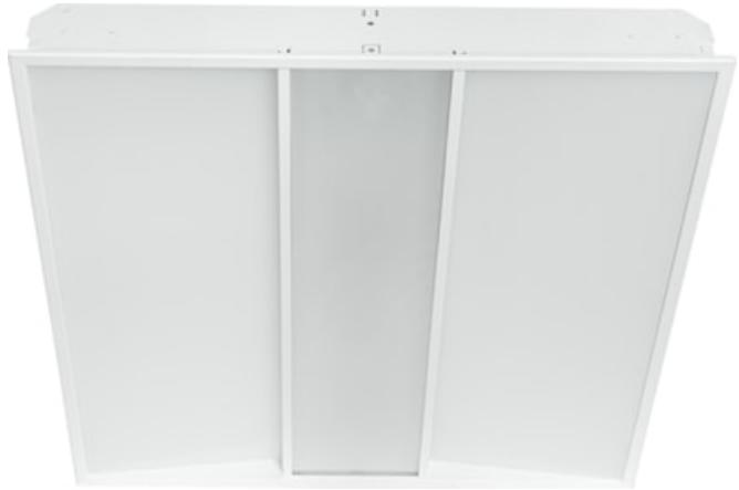
Luminaire LED encastré architectural avec optique micro-prismatique et distribution semi-directe de la lumière. UGR<19. Version haute efficacité (HE) : 134lm/W. Flux lumineux : 3150lm. Température de couleur blanc chaud (3000K). IRC80. Caisson fermé (finition blanc RAL 9016) réduisant la pénétration de la poussière et améliorant le facteur de maintenance du luminaire (LMF). IP20, IK03. Dimensions : 595mm x 595mm x 92mm. Durée de vie 100 000 heures (L80). Garantie 5 ans
