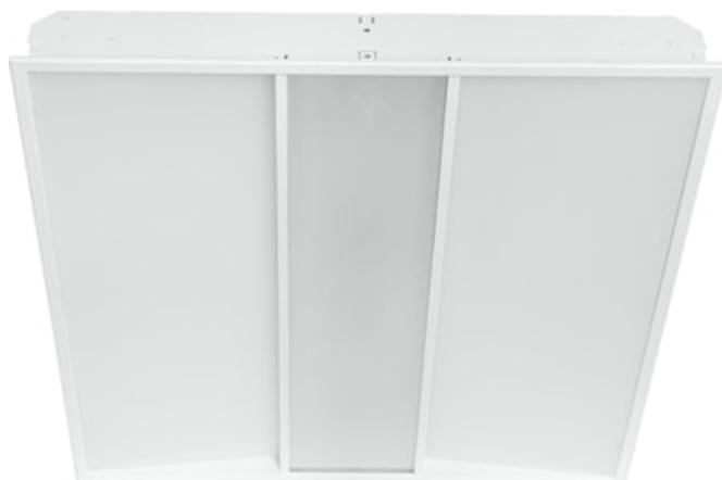
Luminaire LED encastré architectural avec optique micro-prismatique et distribution semi-directe de la lumière. UGR<19. Version haute efficacité (HE) : 134lm/W. Flux lumineux : 3150lm. Température de couleur blanc neutre (4000K). IRC90. Caisson fermé ( finition blanc RAL 9016) réduisant la pénétration de la poussière et améliorant le facteur de maintenance du luminaire (LMF). IP20, IK03. Dimensions : 595mm x 595mm x 92mm. Durée de vie 100 000 heures (L80). Garantie 5 ans
