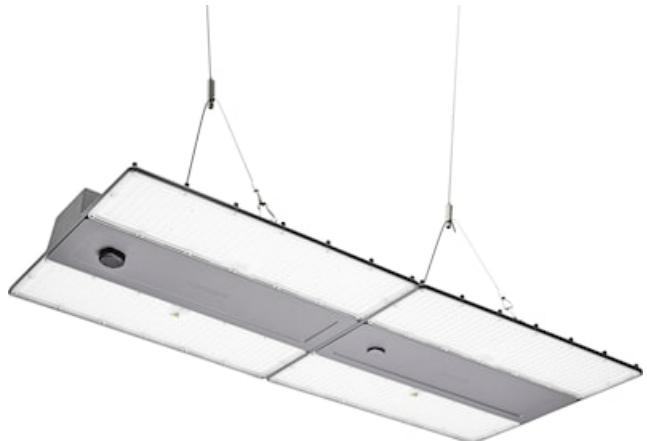
Luminaire grande hauteur pour la logistique et l'industrie. Armature avec angle symétrique Large 75° pour une distribution homogène de l'éclairage. Livré avec un câble d'alimentation de 2m et câbles de suspension de 1m. Corps aluminium et diffuseur polycarbonate. IP65, IK08, Classe I, 4000K, IRC80, SDCM 3. Capteur compatible Zhaga Book 18. Flux lumineux 54000lm, Puissance 290W, Efficacité lumineuse 186lm/W. Durée de vie 105 000h (L80B50).
