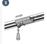
Ré-embrayer la motorisation en manœuvrant la porte manuellement jusqu'à ce que le dispositif d'entraînement vienne se reverrouiller sur le rail de transmission.
