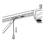
• Débrayer le chariot à l'aide du dispositif de débrayage manuel et amener la porte en position ouverte.
