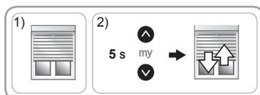
3) Actionner le volet roulant et le **laisser s'arrêter automatiquement** en fin de course haute (si butées) ou basse (si liens rigides).
