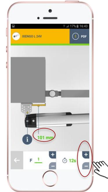
Il est possible de faire varier la vitesse et la force exercée sur le vantail (1 à 7) en tenant compte des contraintes d'installation.
