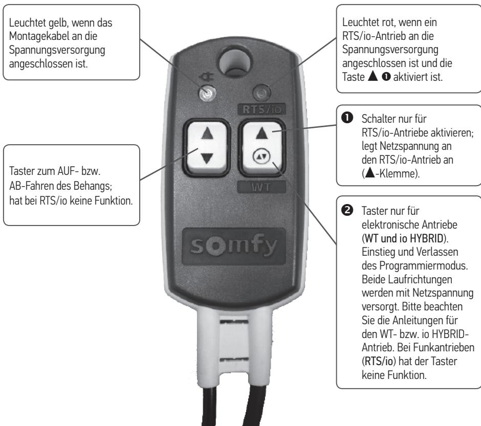
**⚠ Die Tasten **▲ ①** und **▼ ②** dürfen bei den folgenden Antrieben **nicht** betätigt werden: LS-, LT-, LT PA- und Orienta-Antriebe, J41TN/2TN/HTM (Es besteht die Gefahr der Antriebsschädigung!).**
