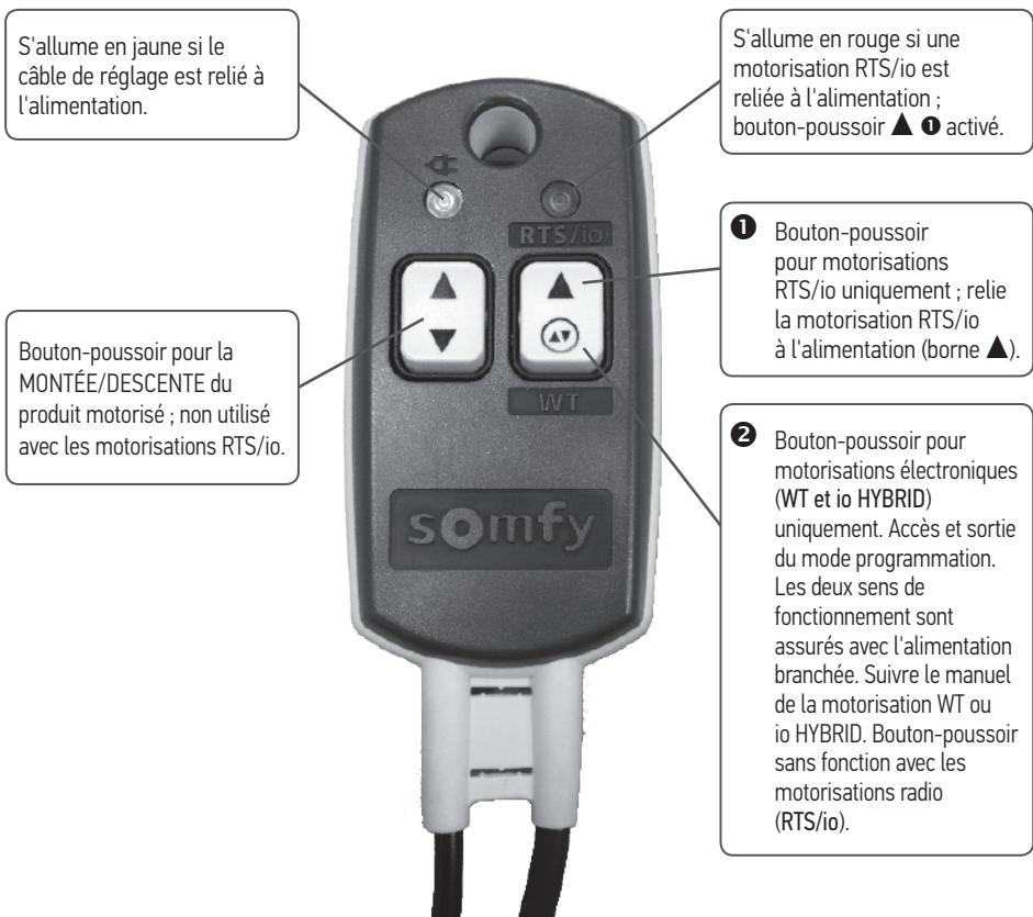
⚠ Les boutons-poussoirs ▲ ① et ▾ ② ne doivent **absolument pas** être actionnés avec les moteurs suivants : LS, LT, LT PA, Orienta, J41TN/2TN/HTM (risque de les endommager !).
