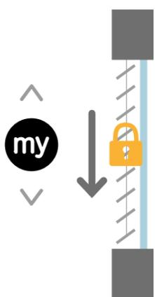
Le BSO descend en position de travail, au niveau de la fin de course basse, lames verrouillées ( $\approx 40^\circ$ ). Le verrouillage s'active par un mouvement automatique de montée.
