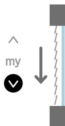
Pour fermer les lames vers l'extérieur, il faut désactiver la position de travail en appuyant sur Descende. Le produit monte puis descend automatiquement, lames fermées.
