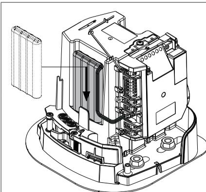
La batterie de secours assure le fonctionnement du portail en cas de défaillance électrique.
