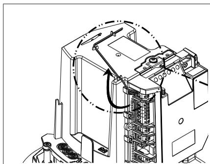
Clipser l'antenne sur le dessus du moteur.
