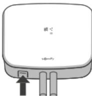
Stisknutím tlačítka „PROG“ přijímače na 3 vteřiny spárujete kotel, tepelné čerpadlo, podlahové vytápění nebo hlavní vodičový radiátor. LED „spojení“ se rozblíká zeleně a režim spárování bude aktivní po dobu 10 minut. Pokud si přejete spárovat bojler samostatně, stiskněte na 6 vteřin tlačítko prog a zelená LED kontrolka blikne podruhé.
