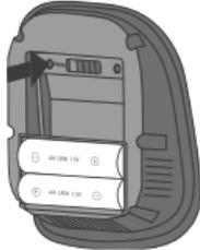
Pulse el botón «PROG» del receptor durante 3 segundos para emparejar la caldera, la bomba de calor, el suelo radiante o el radiador de hilo piloto. El led «conexión ↗» empezará a parpadear en verde y el modo de emparejamiento estará activo durante 10 minutos. Si desea emparejar un calentador de agua independiente, presione el botón «PROG» durante 6 segundos; el led verde parpadeará una segunda vez.
