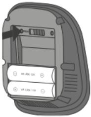
Přední stranu termostatu přiložte k rádiovému přijímači a poté krátce stiskněte tlačítko „PROG“ umístěné nad příhrádkou na baterii termostatu. Během vyhledávání přijímače modrá a červená kontrolka LED termostatu rychle bliknou. Vyčkejte několik vteřin.
