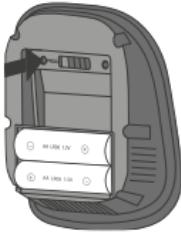
Premere il pulsante "PROG" del ricevitore per 3 secondi per abbinare una caldaia, una pompa di calore, un pannello radiante o un radiatore con filo pilota. Il LED "connessione" si metterà a lampeggiare di colore verde e la modalità abbinamento rimarrà attiva per 10 minuti. Se si desidera abbinare uno scaldabagno indipendente, premere il pulsante prog per 6 secondi, il led verde lampeggerà quindi una seconda volta.
