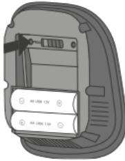
Approcher la face avant du thermostat du récepteur radio, puis faire un appui court sur le bouton «PROG» situé au dessus du compartiment pile du thermostat. Pendant la recherche du récepteur, les LEDS bleue et rouge du thermostat clignoteront rapidement. Attendre quelques secondes.
