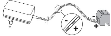
Dans le cas de l'utilisation d'une alimentation sur rail DIN, raccordez les câbles ou les bornes « + » et « - » de l'alimentation aux bornes « + » et « - » du connecteur du moniteur.
