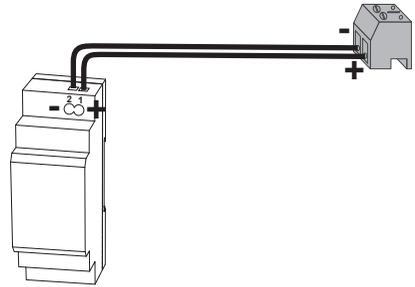
**[3].** Rebranchez le connecteur DC du bloc secteur à l'arrière du moniteur sur le bornier 5-1 dans le sens indiqué sur l'illustration (vis vers la gauche); le sens de connexion des fils du connecteur DC bloc d'alimentation est important.
