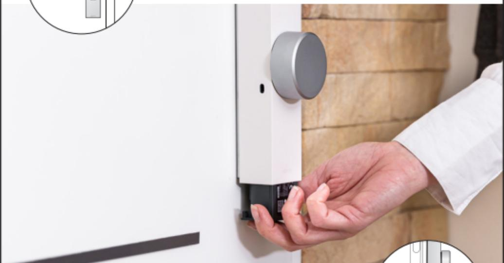
Enlevez la batterie en poussant le levier vers la gauche, et tirez la délicatement vers le bas pour l'extraire du moteur. Rechargez à l'aide du câble USB-C fourni. Durée de la recharge : 8H.
