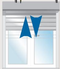
■ Le moteur doit réagir par un mouvement de montée ou de descente de 5 secondes, sinon recommencer cette étape en respectant les temps donnés.
