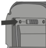
Si no lleva a cabo el emparejamiento en este intervalo de tiempo, presione con un objeto puntiagudo durante 3 segundos el botón PROG en el reverso de la cara delantera del termostato. Compruebe que el módulo de alimentación esté bien colocado retirando la cara delantera del termostato.
