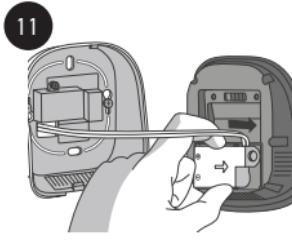
Připevněte modul napájení termostatu io na přední stranu termostatu.
