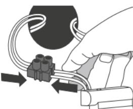
Συνδέστε τα καλώδια του τροφοδοτικού του θερμοστάτου με τα καλώδια τροφοδοσίας που εξέρχονται από το εντοιχισμένο μουσάτ χρωσιμοποιώντας κατάλληλο συνδετήρα.
