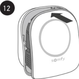
Repousser les câbles au maximum dans la boîte d'encastrement avant de clipper la face avant.
