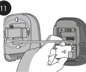
Clipper le module d'alimentation du thermostat io dans la face avant du thermostat.
