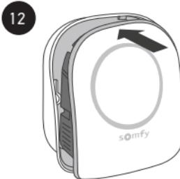
Před připnutím přední části zatlačte kabely na maximum do zapuštěné jednotky.
