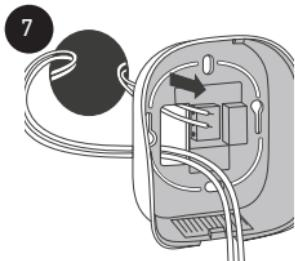
Protáhněte ovládací kabely kotle (NO / COM) zadní části.
