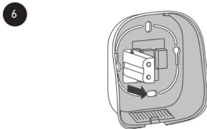
Protáhněte modul napájení termostatu otvorem zadní části termostatu.
