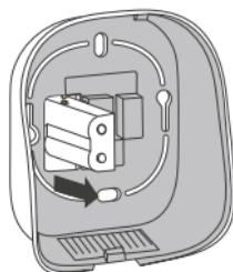
Hacer pasar el módulo de alimentación del termostato por el agujero de la cara trasera del termostato.
