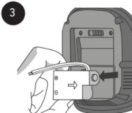
Wyjąć moduł zasilający z przedniej części termostatu.
