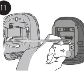
Κουμπώστε το τροφοδοτικό του θερμοστάτη ιο στην πρόσοψη του θερμοστάτη.
