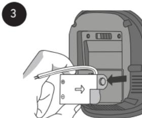
Retirar el módulo de alimentación de la cara delantera del termostato.
