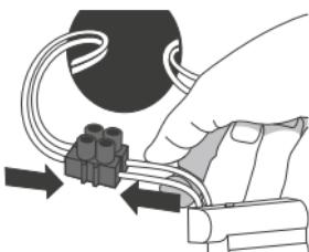
Unir los cables del módulo de alimentación del termostato a los cables de alimentación que salen de la caja empotrada con un conector adecuado.
