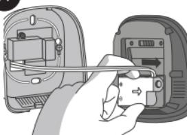
Wpisać moduł zasilający termostatu io w przednią część termostatu.
