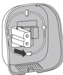
Περάστε το τροφοδοτικό του θερμοστάτου από το άνοιγμα της πίσω πλευράς του θερμοστάτου.
