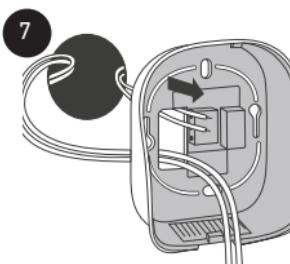
Przełożyć przewody sterowania kotłem (NO / COM) przez część tylną.
