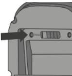
Αν δεν πραγματοποιήσετε τη σύζευξη σε αυτό το χρονικό διάστημα, πιέστε με ένα μυτερό αντικείμενο για 3 δευτερόλεπτα το κουμπί PROG που υπάρχει στην πίσω πλευρά της πρόσωψης του θερμοστάτη. Βεβαιωθείτε ότι το τροφοδοτικό παραμένει στη θέση του καθώς αφαιρείτε την πρόσωψη του θερμοστάτη.
