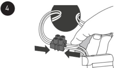
Połączyć przewody modułu zasilającego termostatu z przewodami zasilającymi, które wychodzą ze skrzynki mocującej za pomocą odpowiedniego złącza.
