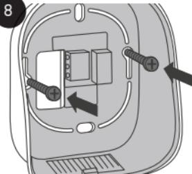
Připevněte zadní stranu termostatu pomocí šroubů zapuštěně jednotky.
