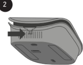
Déclipser la face avant de la face arrière en appuyant sur le point de pression.
