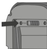
Si vous ne réalisez pas l'appairage dans cet intervalle de temps, à l'aide d'une pointe appuyez pendant 3 secondes sur le bouton PROG au verso de la face avant du thermostat. Veillez à ce que le module d'alimentation reste bien en place en retirant la face avant du thermostat.
