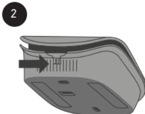
Stisknutím tlakového bodu odepněte přední část zadní strany.
