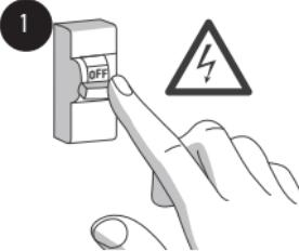
Cortar la alimentación antes de comenzar la instalación del termostato io.
