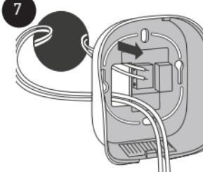
Far passare i cavi di comando della caldaia (NO / COM) tramite il lato posteriore.
