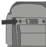
Jeśli powiązanie nie zostanie wykonane w tym przedziale czasu, naciskając przez 3 sekundy ostro zakończonym przedmiotem na przycisk PROG na odwrotnej stronie przedniej części termostatu. Pamiętać, aby moduł zasilania pozostał na swoim miejscu przy zdejmowaniu przedniej części termostatu.
