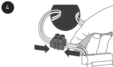
Pomocí vhodného konektoru propojte kabely napájecího modulu termostatu s napájecími kably vedoucími ze zápuštěných jednotky.
