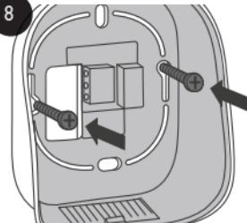
Fixer la face arrière du thermostat en utilisant les vis de la boîte d'encastrement.
