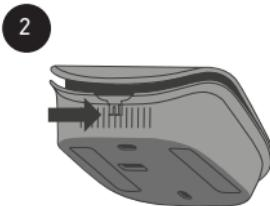
Desenganchar la cara delantera de la cara trasera presionando en el punto de presión.
