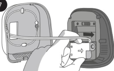
Clipper le module d'alimentation du thermostat io dans la face avant du thermostat.
