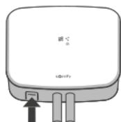
Stisknutím tlačítka „PROG“ přijímače na 3 vteřiny spárujete kotel, tepelné čerpadlo, podlahové vytápění nebo hlavní vodičový radiátor. LED „spojení“ se rozblíží zeleně a režim spárování bude aktivní po dobu 10 minut. Pokud si přejete spárovat bojler samostatně, stiskněte na 6 vteřin tlačítko prog a zelená LED kontrolka blikne podruhé.
