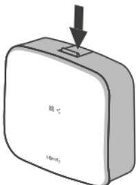
Μην εγκατασθήσετε, στο μέτρο του δυνατού, τον ασύρματο δέκτη υπερβολικά κοντά στο σώμα του λέβητα ή σε οποιοδήποτε άλλο μεταλλικό αντικείμενο το οποίο μπορεί ενδεχομένως να δημιουργήσει παρεμβολές στα ραδιοκύματα. Συνιστάται η στερέωση του ασύρματου δέκτη σε τοίχο κοντά στη συσκευή θέρμανσης κατά τέτοιον τρόπο, ώστε να είναι δυνατή η πρόσβαση στα χειριστήρια (κουμπί PROG + ενδεικτικό).
