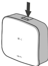
Wenn möglich, installieren Sie den Funkempfänger nicht zu nah am Gehäuse des Heizkessels oder anderer Metallgegenstände, die die Funkwellen beeinträchtigen könnten. Es ist ratsam, den Funkempfänger an der Wand neben dem Heizgerät zu montieren, um Zugang zu den Bedienelementen (PROG-Taste + LED) zu haben.
