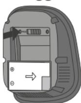
Nacisnąć krótko na przycisk "PROG" umieszczony nad komorą na baterie termostatu. Podczas wyszukiwania odbiornika, niebieska i czerwona dioda LED na termostacie będą szybko migać. Począć kilka sekund.
