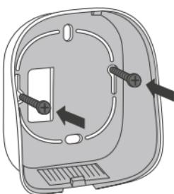
Befestigen Sie das hintere Teil des Heizkörper-Thermostaten io mit den Schrauben auf dem Wandkasten oder mit den mitgelieferten Schrauben und Dübeln.
