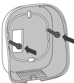
Fixez la face arrière du thermostat io en utilisant les vis de la boîte d'encastrement ou les vis et chevilles fournies
