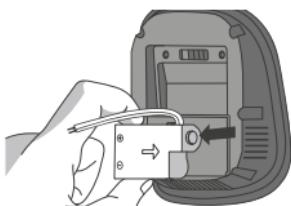
Nehmen Sie das Netzteil aus dem Frontteil des Thermostaten.
