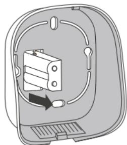
Hacer pasar el módulo de alimentación del termostato io por el agujero de la cara trasera del termostato.
