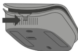
Desenganchar la cara delantera de la cara trasera presionando en el punto de presión.
