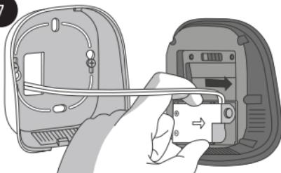
Připněte modul napájení termostatu io na přední stranu termostatu.
