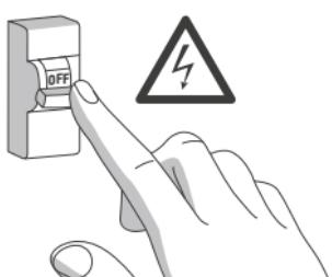
Unterbrechen Sie die Spannungsversorgung, bevor Sie mit der Installation des Heizkörper-Thermostaten io beginnen.
