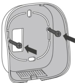
Fissare il lato posteriore del termostato io utilizzando le viti della scatola da incasso oppure le viti e i tasselli forniti
