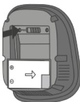
Premere brevemente il pulsante "PROG" posizionato al di sopra del comparto batterie del termostato. Durante la ricerca del ricevitore, i LED blu e rosso del termostato lampeggiano rapidamente. Attendere qualche secondo.
