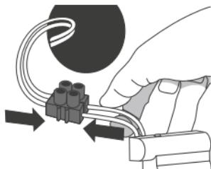
Συνδέστε τα καλώδια του τροφοδοτικού του θερμοστάτη με τα καλώδια τροφοδοσίας που εξέρχονται από το εντοιχισμένο μπουάτ χρησιμοποιώντας κατάλληλο συνδετήρα.
