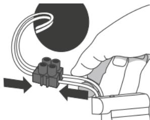
Collegare i cavi del modulo di alimentazione del termostato ai cavi di alimentazione che escono dalla scatola da incasso servendosi di un apposito connettore.
