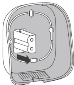
Schieben Sie das Netzteil des Thermostaten durch die Öffnung im hinteren Teil des Thermostaten.
