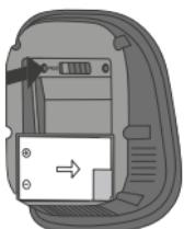
Faire un appui court sur le bouton «PROG» situé au dessus du compartiment pile du thermostat. Pendant la recherche du récepteur, les LEDS bleue et rouge du thermostat clignoteront rapidement. Attendre quelques secondes. Si la LED bleue a clignoté 3 fois, l'appairage a été réalisé avec succès. Sur le récepteur la LED connexion restera vert fixe.
