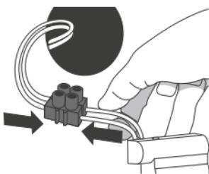
Schließen Sie die Kabel des Netzteils des Thermostaten mit einem geeigneten Verbindungsstecker an die Stromkabel aus dem Wandkasten an.
