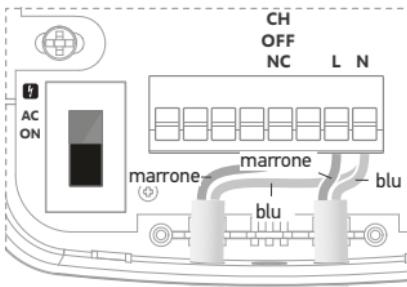
**Installazione per scaldabagno:** collegare il cavo marrone al morsetto CH ON. Successivamente, collegare il cavo marrone al morsetto L per la fase e quello blu al neutro N. Quindi collegare l'altra estremità di questo secondo cavo al quadro elettrico (L alla fase e N al neutro). Infine, posizionare l'interruttore del ricevitore su AC ON.
