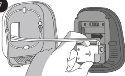
Κουμπώστε το τροφοδοτικό του θερμοστάτη ιο στην πρόσοψη του θερμοστάτη.
