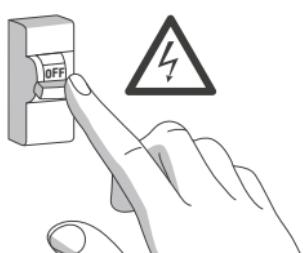
Cortar la alimentación antes de comenzar la instalación del termostato io.
