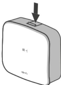
Per quanto possibile, non installare il ricevitore troppo vicino al corpo della caldaia o a ogni altro oggetto metallico che potrebbe disturbare le onde radio. Si consiglia di fissare il ricevitore radio al muro e nella zona periferica dell'apparecchio di riscaldamento, in modo tale da poter accedere ai comandi (pulsante PROG + spia).
