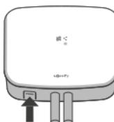
Premere il pulsante "PROG" del ricevitore per 3 secondi per abbinare una caldaia, una pompa di calore, un pannello radiante o un radiatore con filo pilota. Il LED "connessione" si metterà a lampeggiare di colore verde e la modalità abbinamento rimarrà attiva per 10 minuti. Se si desidera abbinare uno scaldabagno indipendente, premere il pulsante prog per 6 secondi, il led verde lampeggerà quindi una seconda volta.
