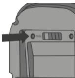
Pokud spárování neprovedete v tomto časovém intervalu, stiskněte pomocí tenkého hrotu na 3 vteřiny tlačítko PROG na zadní straně čelního panelu termostatu. Sejmůžte čelního panelu termostatu zkонтrolujte, zda je napájecí modul na svém místě.
