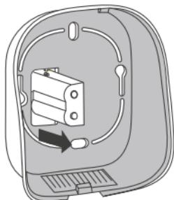
Protáhněte modul napájení termostatu otvorem zadní části termostatu.
