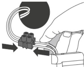
Pomocí vhodného konektoru propojte kabely napájecího modulu termostatu s napájecími kably vedoucími ze zapuštěné jednotky.
