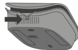
Lösen Sie das Frontteil vom hinteren Teil des Thermostaten, indem Sie auf den Druckpunkt drücken.
