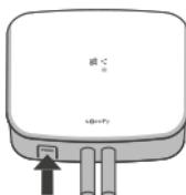
Appuyez sur le bouton «PROG» du récepteur pendant 3 secondes pour appairer une chaudière, pompe à chaleur, plancher chauffant ou radiateur fil pilote. La LED «connexion» se mettra à clignoter en vert et le mode appairage sera actif pendant 10 minutes. Si vous souhaitez appairer un ballon d'eau chaude indépendant, appuyez pendant 6 secondes sur le bouton prog, la led verte clignotera alors une seconde fois.
