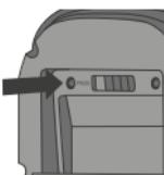
Se l'abbinamento non viene eseguito entro tale intervallo di tempo, servirsi di un oggetto appuntito per premere il pulsante PROG per 3 secondi sul retro del lato anteriore del termostato. Verificare che il modulo di alimentazione resti saldamente in posizione durante lo smontaggio del lato anteriore del termostato.
