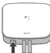
Naciśnąć przez 3 sekundy na przycisk "PROG" odbiornika w celu powiązania kotła, pomp ciepła, ogrzewania podłogowego lub grzejnika z przewodem sterującym. Dioda LED "połączenie" zacznie migać na zielono i tryb powiązania będzie aktywny przez 10 minut. Jeśli ma zostać powiązany niezależny zbiornik ciepłej wody, należy nacisnąć przez 6 sekund na przycisk prog, zielona dioda LED będzie migać po raz kolejny.
