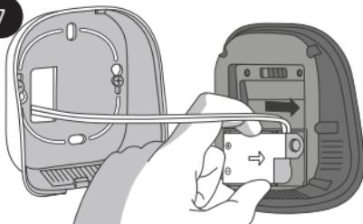
Encazar el módulo de alimentación del termostato io en la cara delantera del termostato.
