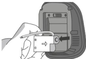
Retirar el módulo de alimentación de la cara delantera del termostato.
