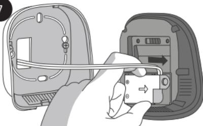
Agganciare il modulo di alimentazione del termostato io al lato anteriore del termostato.
