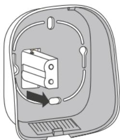
Faire passer le module d'alimentation du thermostat au travers de l'orifice de la face arrière du thermostat.
