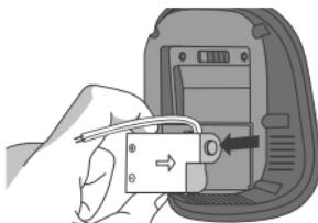
Wyjąć moduł zasilający z przedniej części termostatu.
