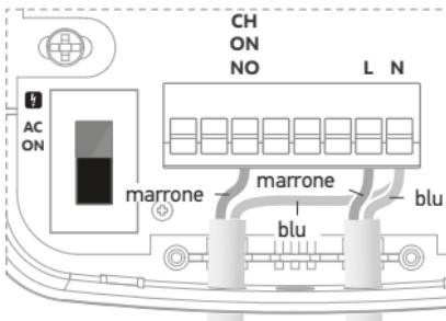
**Installazione per pannello radiante NO:** collegare i morsetti NC e N del ricevitore (attenzione: una valvola NO viene collegata al morsetto NC del ricevitore). Quindi, collegare i 2 cavi alla valvola NO. Successivamente, collegare il cavo marrone al morsetto L per la fase e quello blu al neutro N. Collegare l'altra estremità di questo secondo cavo al quadro elettrico (L alla fase e N al neutro). Infine, posizionare l'interruttore del ricevitore su AC ON.
