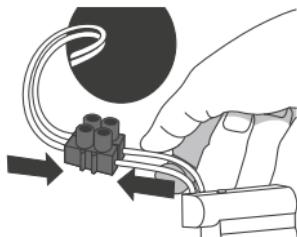
Połączyć przewody modułu zasilającego termostatu z przewodami zasilającymi, które wychodzą ze skrzynki mocującej za pomocą odpowiedniego złącza.
