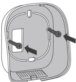
Zamocować tylną część termostatu io za pomocą śrub puszki montażowej albo śrub i kołków dostarczonych wraz z produktem
