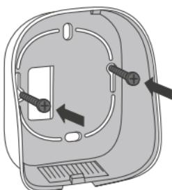
Στερεώστε την πίσω πλευρά του θερμοστάτη ιο χρησιμοποιώντας τις βίδες του εντοιχισμένου μπουάτ ή τις παρεχόμενες βίδες και βύσματα.
