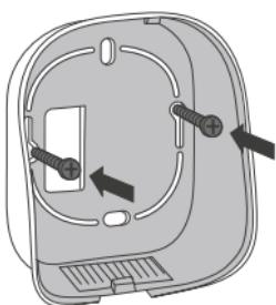
Fije la cara trasera del termostato io con los tornillos de la caja empotrada o los tornillos y los tacos incluidos.
