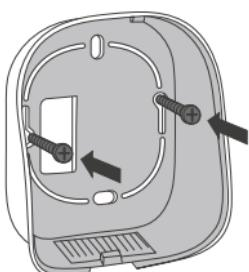
Připevněte zadní stranu termostatu io pomocí šroubů zapuštěné jednotky nebo pomocí dodaných šroubů a hmoždinek.
