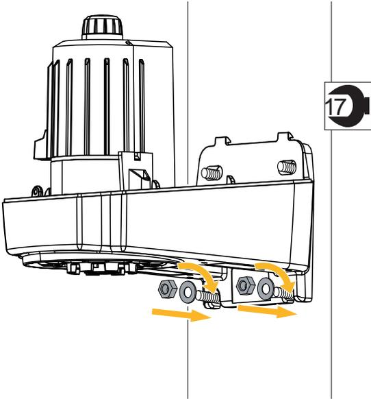
• Positionner le moteur en le fixant aux tiges filetées inférieures avec les rondelles et les écrous.
