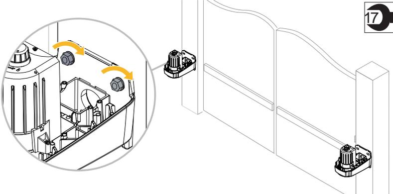
• Fixer le moteur sur les tiges filetées supérieures, à l'aide des rondelles et des écrous.
