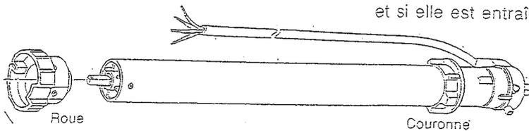
NB : en cas de test du moteur hors tube, il faut tourner manuellement la couronne afin d'entraîner le système fin de course.
