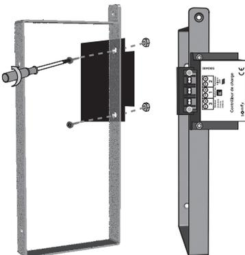
Vissez le contrôleur de charge (7) sur la bride (6) en introduisant les vis (5D) par dessous et en positionnant les écrous (5C) sur le dessus du contrôleur.
