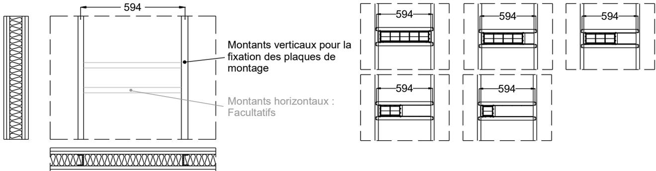
Distance entre les modules EZ-Path et les points de fixation
