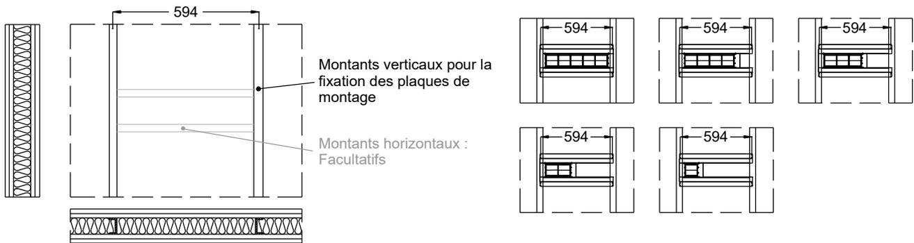
Distance entre les modules EZ-Path et les points de fixation
