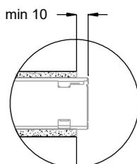
Épaisseur du mur en mm. Module seul ou avec extension EZZ33E pour cloison épaisse.
