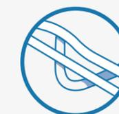
Bord de sécurité soudé en T (système breveté) et fils de forme arrondie pour sécuriser la pose et le tirage des câbles (pour les largeurs à partir de 100 mm).
