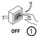
Switch off the electrical installation before installation / Coupez l'électricité au tableau avant tout installation
