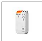
S.2495 DALI2 RELAY SWITCH pour ON-OFF (NON GRADABLES) 230V APPAREILS Tous les appareils fonctionnant à 230V non gradables (ON-OFF) peuvent être contrôlés ON-OFF avec le système DALI2 avec les accessoires interfaces suivants. Il s'en suit que l'appareil sera contrôlé à distance dans le seul mode ON-OFF et non pas en mode gradable. IP20 Max nominal load 1000VA Max switching current 8A Max inrush current 80A Dimensions 32,5mm x 15mm x 58,5mm La somme des courants d'appel des dispositifs à connecter à cette interface ne doit pas dépasser la valeur maximale tolérable de 80A.
