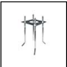
S.2840 Embase de fixation à sceller pour POTEAU S.2846, S.2848 en acier zincé avec visserie M16, hauteur totale = 550 mm. Il est conseillé de sceller cette embase dans le béton selon les dimensions ci-dessous **: A = 0,7 m B = 1 m
