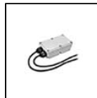
S.2496 DALI2 RELAY SWITCH pour ON-OFF (NON GRADABLES) 230V APPAREILS Tous les appareils fonctionnant à 230V non gradables (ON-OFF) peuvent être contrôlés ON-OFF avec le système DALI2 avec les accsoires interfaces suivants. Il s'en suit que l'appareil sera contrôlé à distance dans le seul mode ON-OFF et non pas en mode gradable. IP67 Max nominal load 1000VA Max switching current 8A Max inrush current 80A Dimensions 175,5mm x 86,5mm x 43mm La somme des courants d'appel des dispositifs à connecter à cette interface ne doit pas dépasser la valeur maximale tolérable de 80A.
