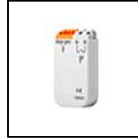
S.2495 DALI2 RELAY SWITCH pour ON-OFF (NON GRADABLES) 230V APPAREILS Tous les appareils fonctionnant à 230V non gradables (ON-OFF) peuvent être contrôlés ON-OFF avec le système DALI2 avec les accessoires interfaces suivants. Il s'en suit que l'appareil sera contrôlé à distance dans le seul mode ON-OFF et non pas en mode gradable. IP20 Max nominal load 1000VA Max switching current 8A Max inrush current 80A Dimensions 32,5mm x 15mm x 58,5mm La somme des courants d'appel des dispositifs à connecter à cette interface ne doit pas dépasser la valeur maximale tolérable de 80A.
