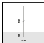
S.2842 POTEAU CYLINDRIQUE H 3,5m Ø60mm À ENTERRER
