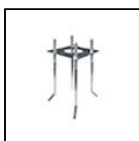
S.2849 Embase de fixation à sceller pour POTEAU S.2801, S.2813, S.2843, S.2845 à sceller en acier zingué avec visserie M16, C= 200mm, D=200mm E=Ø80mm, h=460mm, h1=90mm. Il est conseillé de sceller cette embase dans le béton selon les dimensions ci-dessous **: A = 0.7 m B = 0.7 m **Les dimensions du bloc de béton peuvent varier en fonction de la nature du terrain, selon les indications de la norme UNI EN 40. NOUS RECOMMANDONS D'UTILISER LES ACCESSOIRES SUIVANTS : S.2801, S.2813, S.2843, S.2845 POTEAU
