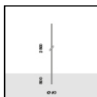
S.2800 POTEAU CYLINDRIQUE H 2,5m Ø60 mm À ENTERRER
