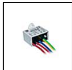
S.2498 DÉCHARGEUR DE SURTENSION 10kV CLASSE I Compatible avec tous les appareils d'éclairage en classe d'isolation CLASSE I Tension de fonctionnement 230-277V SPD type 2+3 Tension maximale de décharge 10kV Indice de protection IP67 IL FAUT PRÉVOIR POUR CHAQUE APPAREIL D'ÉCLAIRAGE UN DÉCHARGEUR DE SURTENSION; IL DOIT ÊTRE INSTALLÉ À UNE DISTANCE MAXIMALE DE 10m DE CE DERNIER.
