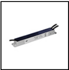
S.2416 ALIMENTATION ELECTRONIQUE DIMMABLE 230Vac/24Vdc 75W 244Hz IP67 75W 230Vac/24Vdc Le nombre maximum d'appareils dépend de la somme des puissances unitaires de l'appareil. IP67 CLASSE II SELV PWM Frequency : 244Hz Dimensions 280 x 40x 28mm L'UTILISATION DU DÉCHARGEUR À SURTENSION S.2499 EST RECOMMANDÉE POUR CHAQUE BALLAST ÉLECTRONIQUE QUI DOIT ÊTRE INSTALLÉ À UNE DISTANCE MAXIMALE DE 10m DE CELUI-CI.
