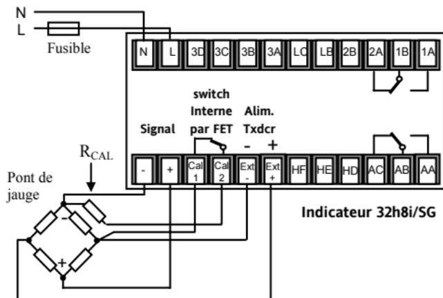
Les réglages haut (étendue) et bas (zéro) du transducteur peuvent être réalisés automatiquement ou manuellement. Le réglage manuel permet de calibrer individuellement les points haut et bas. Le réglage automatique effectue la calibration des points haut et bas par la sélection d'un paramètre.
