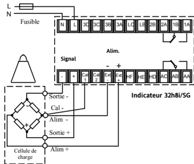
Si une cellule de 5/6 fils est utilisée le Capteur Cal- doit être connecté à la borne Cal 1 comme indiqué ci-contre. Il n'y a pas de connexion pour le Capteur +.
