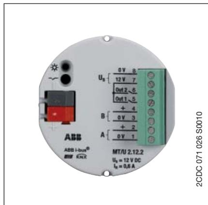
Das Sicherheitsterminal MT/U 2.12.2 findet Anwendung als Schnittstelle zwischen Sensoren der Sicherheitstechnik und dem KNX. Das Gerät besitzt 2 Eingänge, sogenannte Meldergruppen. Sie dienen dem überwachten Anschluss von passiven Meldern, z.B. Magnetkontakten und/oder Glasbruchsensoren an ABB i-bus® KNX und/oder zum Anschluss von potentialfreien Kontakten in Anwendung mit erhöhten Sicherheitsanforderungen.
