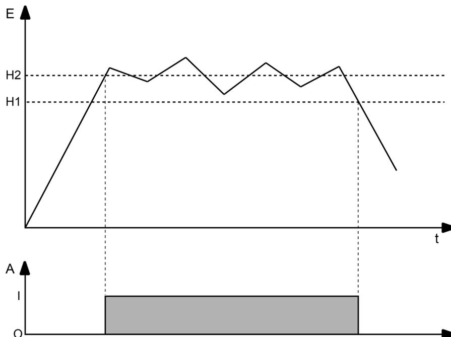
Bild 27: Beispiel einer Hystereseauswertung durch oberen und unteren Schwellwert
