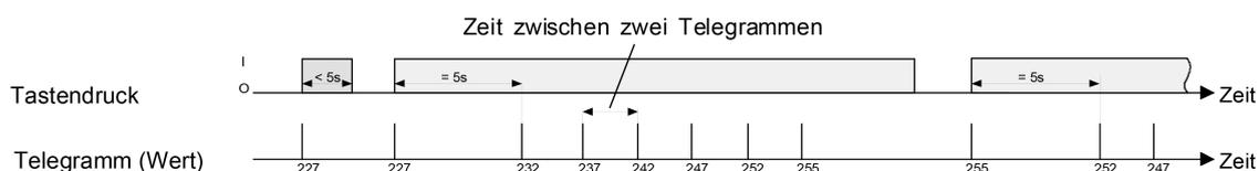
Bild 15: Beispiel zur Wertverstellung ohne Wertbereichs-Überlauf
