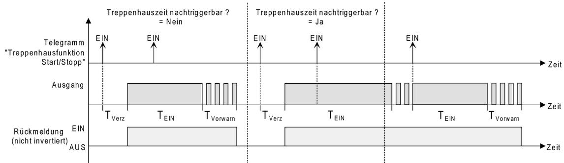
Bild 3: Einschaltverhalten der Treppenhausfunktion
