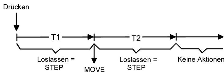
Bild 14: Bedienkonzept "Lang – Kurz oder Kurz"
