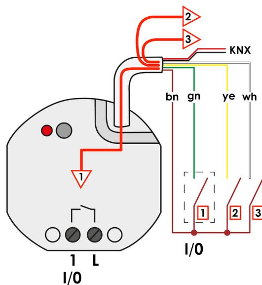
Bild 9: Funktionsweise des Eingangs 1 bei Ansteuerung des internen Schaltausgangs als Einflächenbedienung
