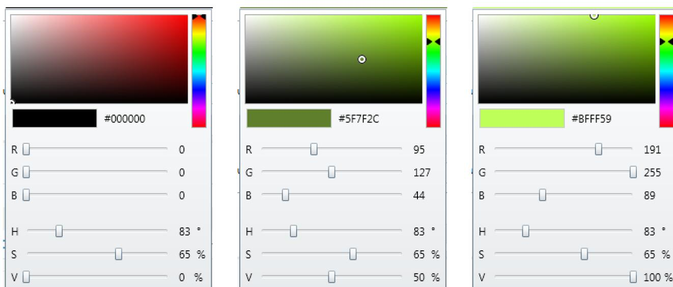
Bild 20: Beispiele zur Helligkeitsverstellung anhand des Color Pickers der ETS
