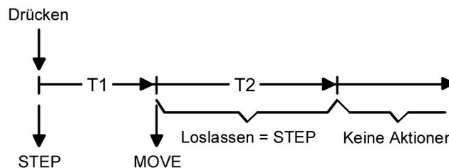
Bild 11: Bedienkonzept "Kurz-Lang-Kurz"
