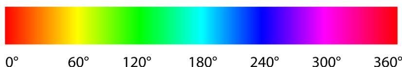
Bild 17: Farbtonskala (Farbwinkel H)
