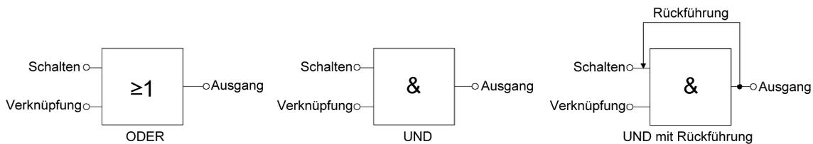
Bild 7: Verknüpfungsarten der Verknüpfungsfunktion
