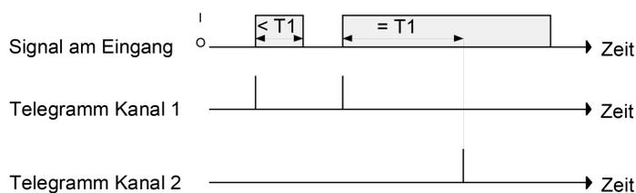
Bild 22: Beispiel zum Bedienkonzept "Kanal 1 und Kanal 2"
