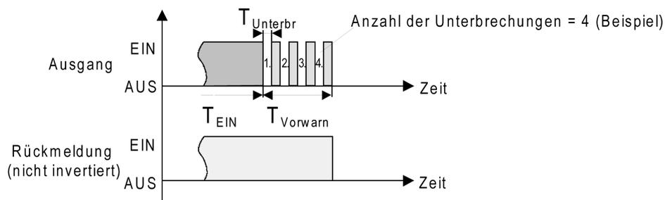
Bild 5: Die Vorwarnfunktion der Treppenhausfunktion (Beispiel)
