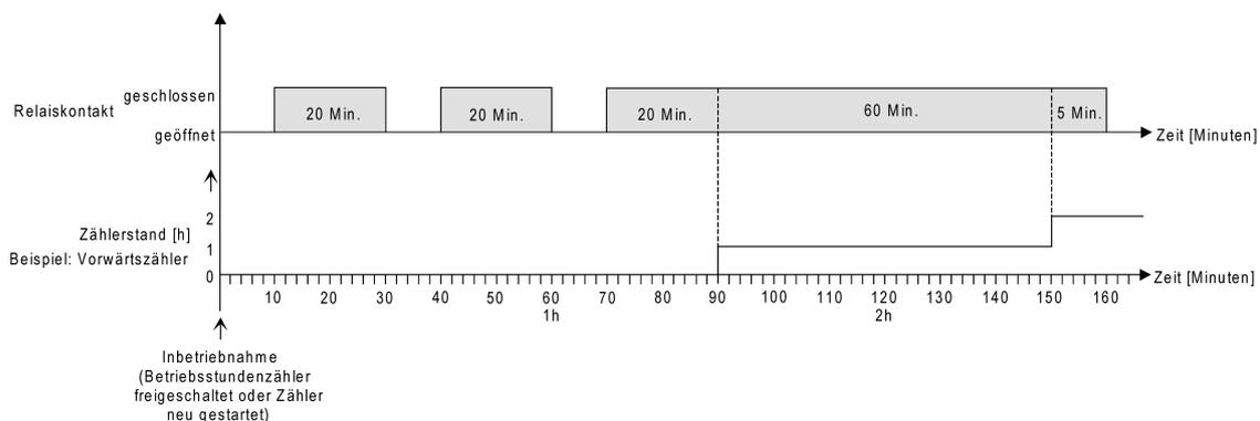
Bild 8: Funktionsweise des Betriebsstundenzählers (am Beispiel gezählter Stunden)
