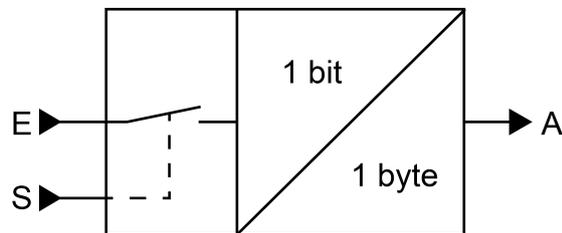
Bild 23: Umsetzer (1 Bit -> 1 Byte)
