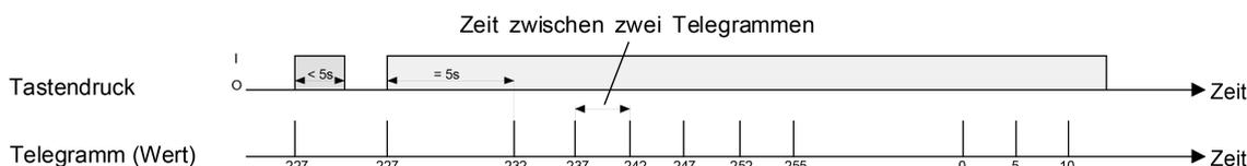
Bild 16: Beispiel zur Wertverstellung mit Wertbereichs-Überlauf
