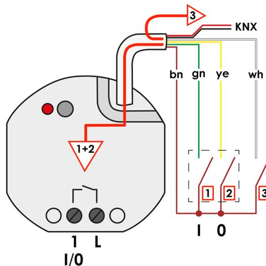
Bild 10: Funktionsweise der Eingänge bei Ansteuerung des internen Schaltausgangs als Zweiflächenbedienung
