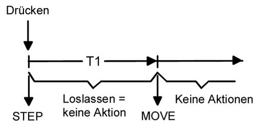
Bild 13: Bedienkonzept "Kurz - Lang"
