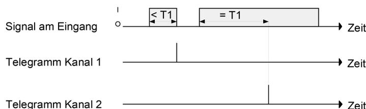
Bild 21: Beispiel zum Bedienkonzept "Kanal 1 oder Kanal 2"
