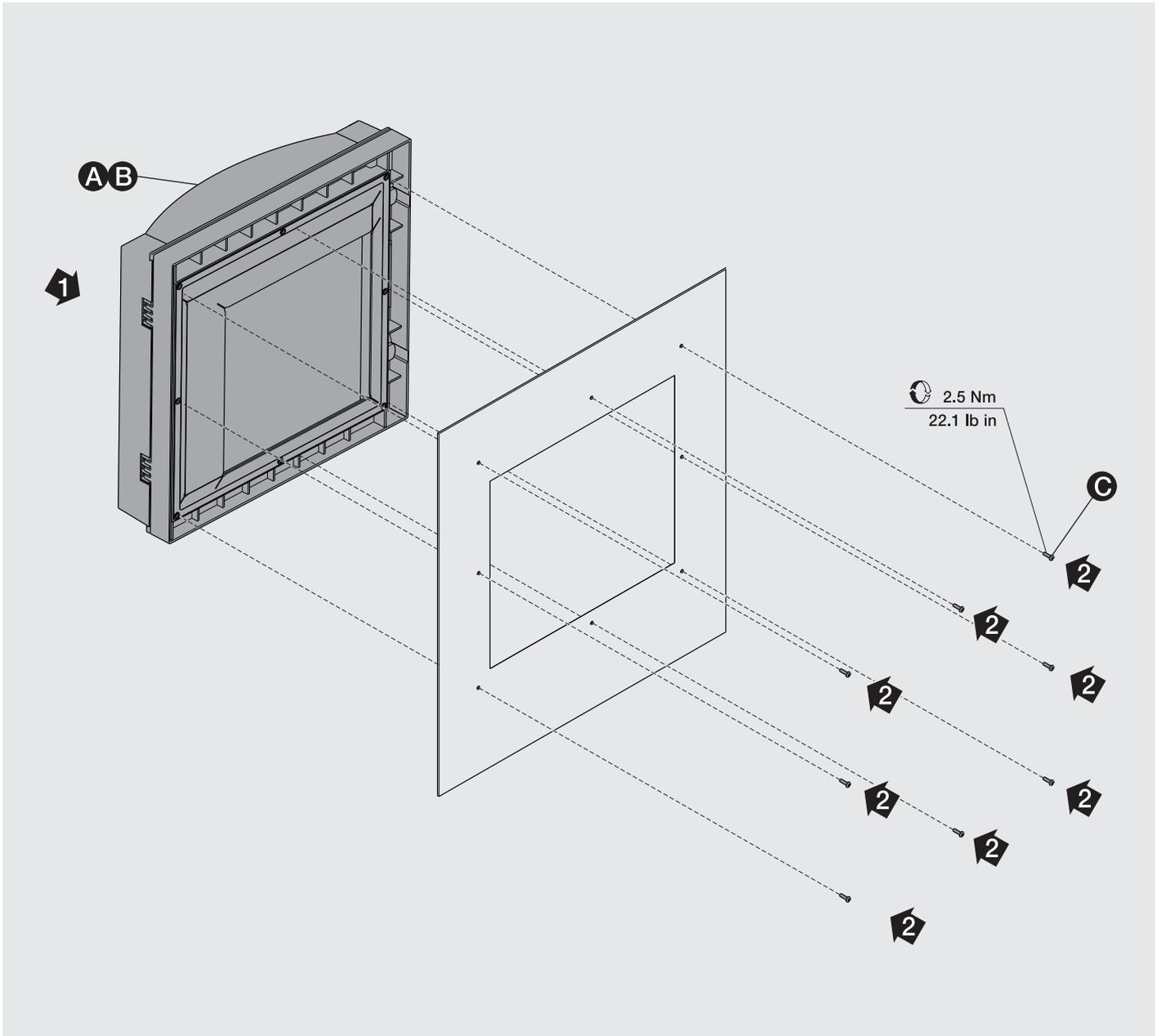
In esecuzione fissa verificare che la guarnizione sia montata sempre rivolta verso l'alto
