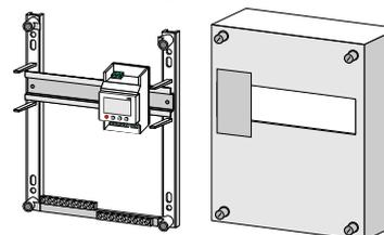
T2S+2C digit est monté sur rail DIN en armoire électrique
