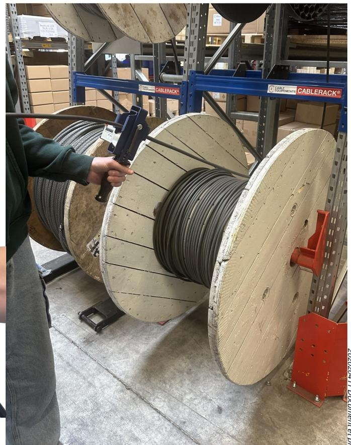
Par principe la mesure par défillement d'un produit long ne peut pas être d'une précision parfaite. Il incombe à l'utilisateur de réaliser ses propres essais pour déterminer le pourcentage de précision pour les différents produits à mesurer.
