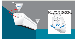
Pose et réglage au plafond
